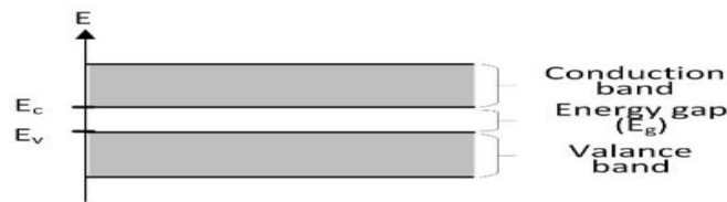
الشكل يوضح حزم الطاقة في المواد الشبه موصلة
